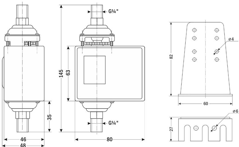
Рис. 3. Габаритные и присоединительные размеры реле перепада давления
